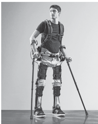
Рис. 8. Экзоскелет восполняет утраченные функции нижних конечностей
