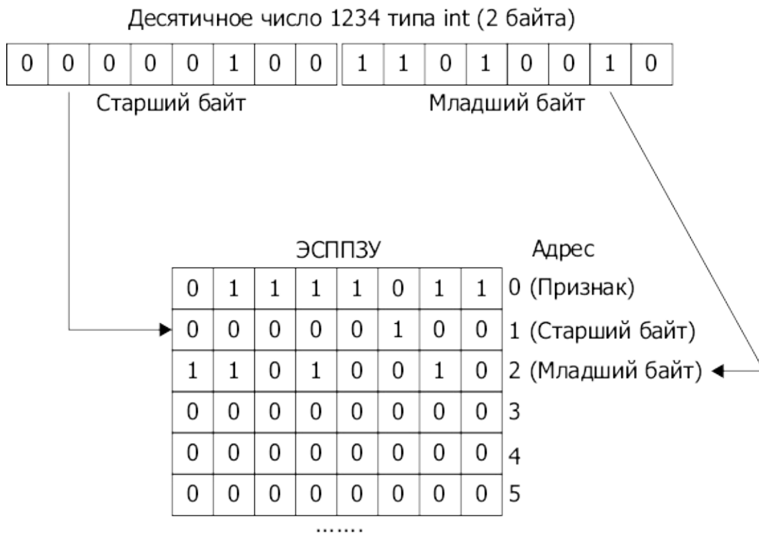
Рис. 6.5. Хранение значения типа int в ЭСППЗУ
